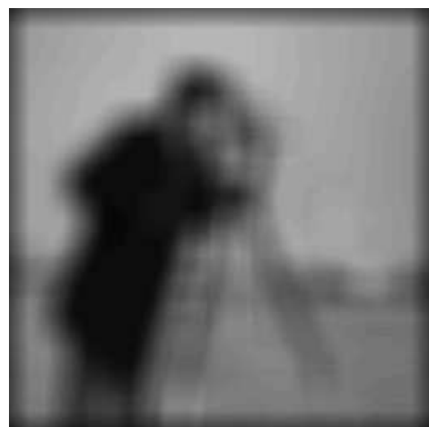
(d) Using a 25 \times 25 filter
