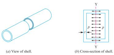
Fig. 7.3. Longitudinal stress.
