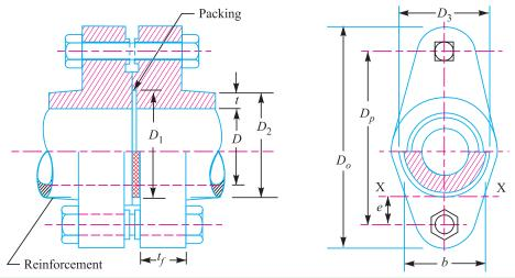
Fig. 8.11. Hydraulic pipe joint.
