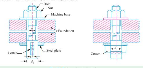
Fig. 12.15. Cotter foundation bolt.
